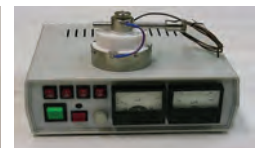
Магнетрон МАГ-2000 с блоком управления
