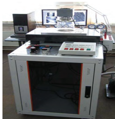
STM/AFM in-situ под магнетронами
