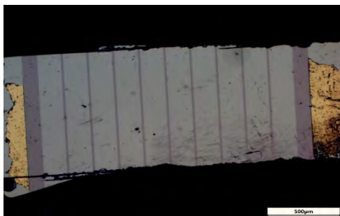
Рис. 1. Изображение разрезанного слоя пермаллоя
