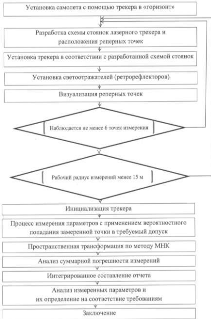
Рис.4 Совершенствованная методика контроля геометрических параметров воздушного судна
