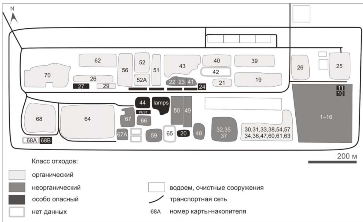
Рис. 2. Схема расположения карт-накопителей полигона «Красный Бор».
