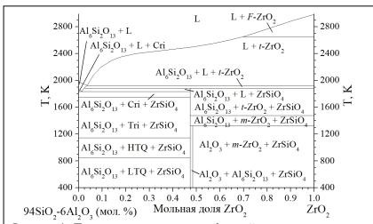
Рисунок 1. Политермическое сечение фазовой диаграммы системы  $Al_2O_3$ -SiO $_2$ -ZrO $_2$ , рассчитанное с использованием базы данных NUCLEA.  $Al_6Si_2O_{13}$  — муллит, L — расплав,  $ZrSiO_4$  — циркон, LTQ, HTQ, Tri и Cri — полиморфные модификации оксида кремния: низкотемпературный кварц, высокотемпературный кварц, тридимит и кристобалит соответственно.
