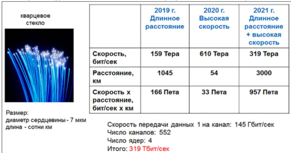
Рис. 4. Гигантские объёмы информации и с большой скоростью могут быть переданы с помощью оптического кварцевого волокна на большие расстояния (компания NICT, Япония)
