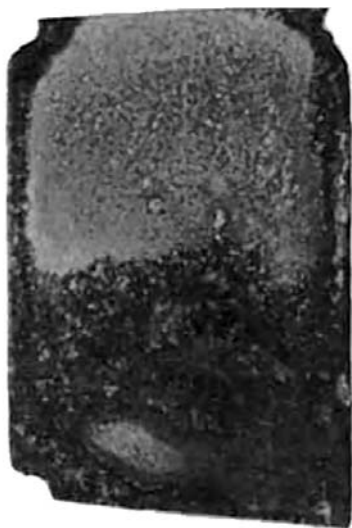
Рис. 1. Направленный эрозионно-коррозионный износ элемента стальной конструкции с гальваническим покрытием после 1,5 лет эксплуатации в морском климате [4]
