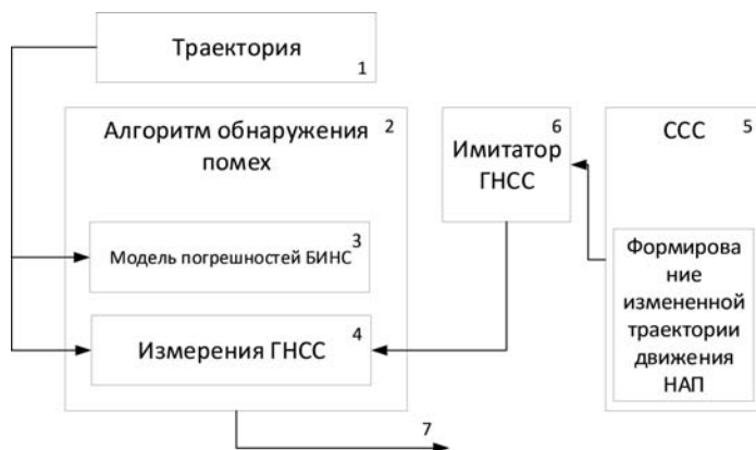
Рис. 1. Структура программно-аппаратного комплекса полунатурного моделирования
