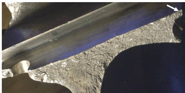
Рис. 1. Поверхность излома элемента авиационной конструкции (диск компрессора ГТД) с выявленным очагом зарождения усталостного разрушения (стрелка)
