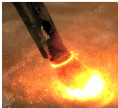
Рис. 1. Воздействие на электропроводящую оснастку/приспособление новым видом ВЧЕ-разряда кольцевой формы с микроканалами
