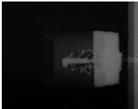
Рис. 2. Стальной ударник в момент 87 мкс; полиэтилен — 94 мм
