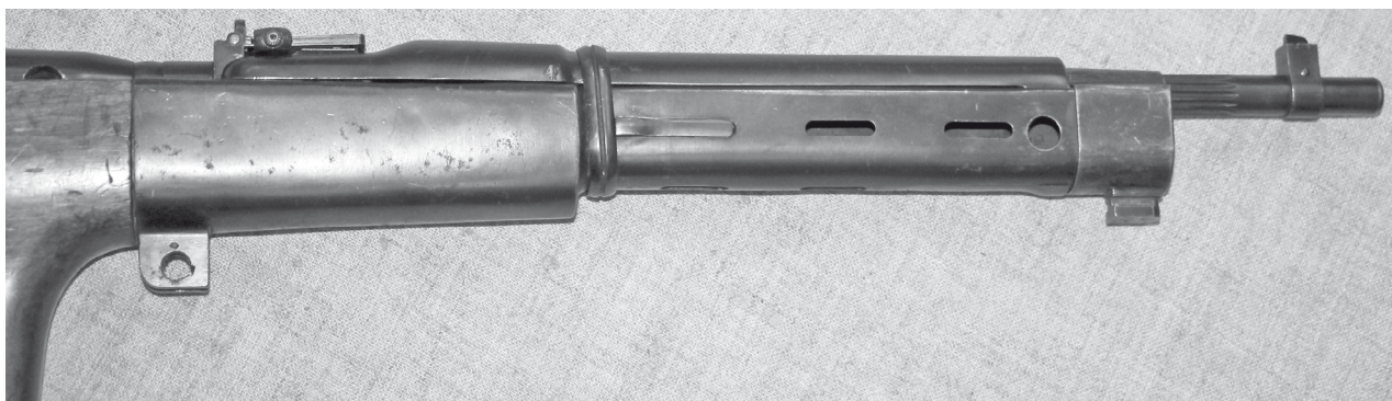
Рис. 33. Автомат Фёдорова с/н 3234, вид справа на дульную часть оружия. Обращают на себя внимание удлинённое металлическое цевьё с проушиной и круглым отверстием позади наконечника
