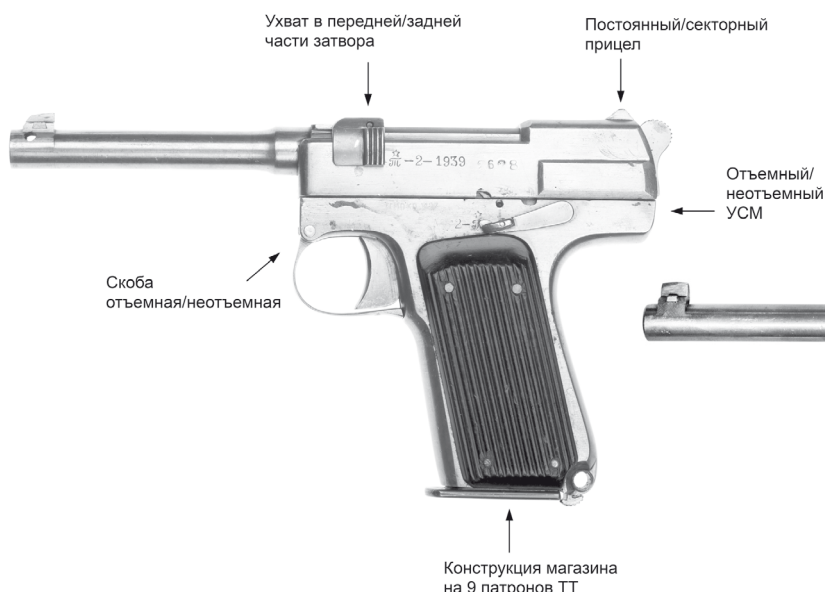
Рис. 6. Наиболее характерные изменения-конструкции ТКБ-182 в течение 1939 г.
