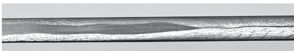
Рис. 5. Участок обуха клинка в месте перехода двухслойного пакета (боевой конец) в трехслойный пакет (средняя часть)
