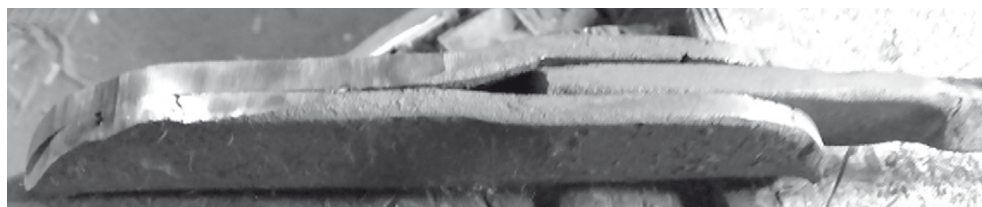
Рис. 3. Вид трехслойного пакета перед кузнечной сваркой
