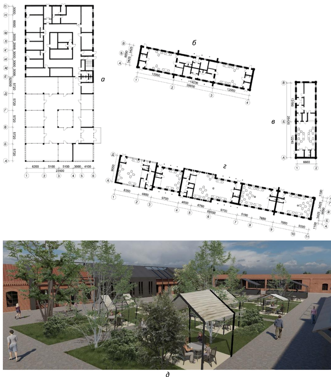
Рис. 7. Здания торговой зоны: а – рынок с ветеринарно-санитарной экспертизой продуктов; б–г – здания ресторанов и кафе; д – общий вид
