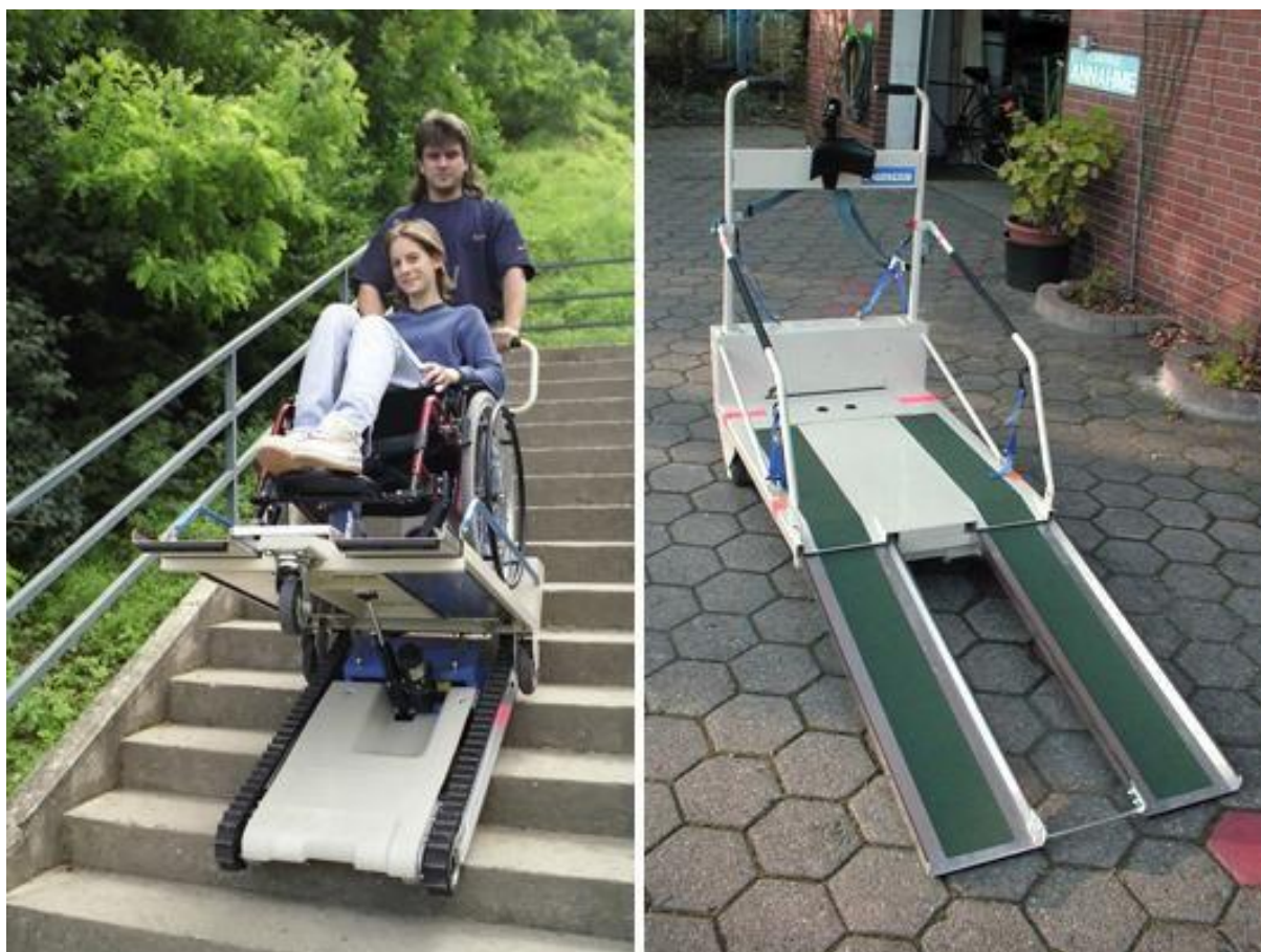
Рис. 5. Лестничный гусеничный мобильный подъемник
