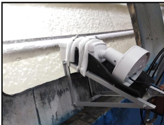
Рисунок 4 - Закрепление камеры на кожухе барабана
