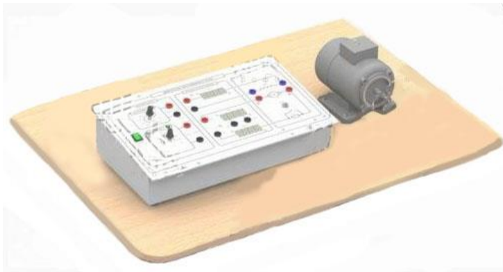
Рисунок 1 – Комплект учебного оборудования "Двигатель постоянного тока", исполнение моноблочное ручное, ДПТ-МР
