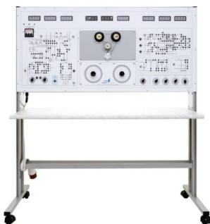
Рисунок 2. – Лабораторный стенд НТЦ-06.03 «Электрические машины»
