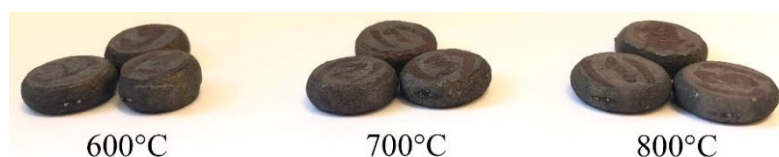
Рис. 4. Деформированные образцы группы «смешанная» при температурных испытаниях
