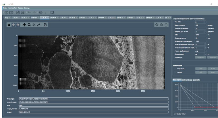
Рис. 2. Вид основного окна графического модуля оператора полезной нагрузки с сформированным радиолокационным изображением ледовой поверхности
