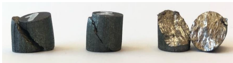
Рис.3. Разрушенные образцы группы «смешанная» при комнатной температуре
