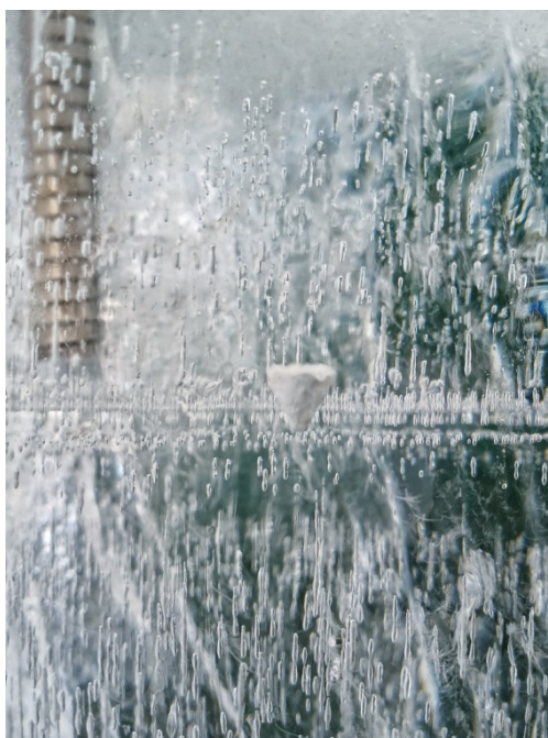
Рис.2 – включения в образце льда
