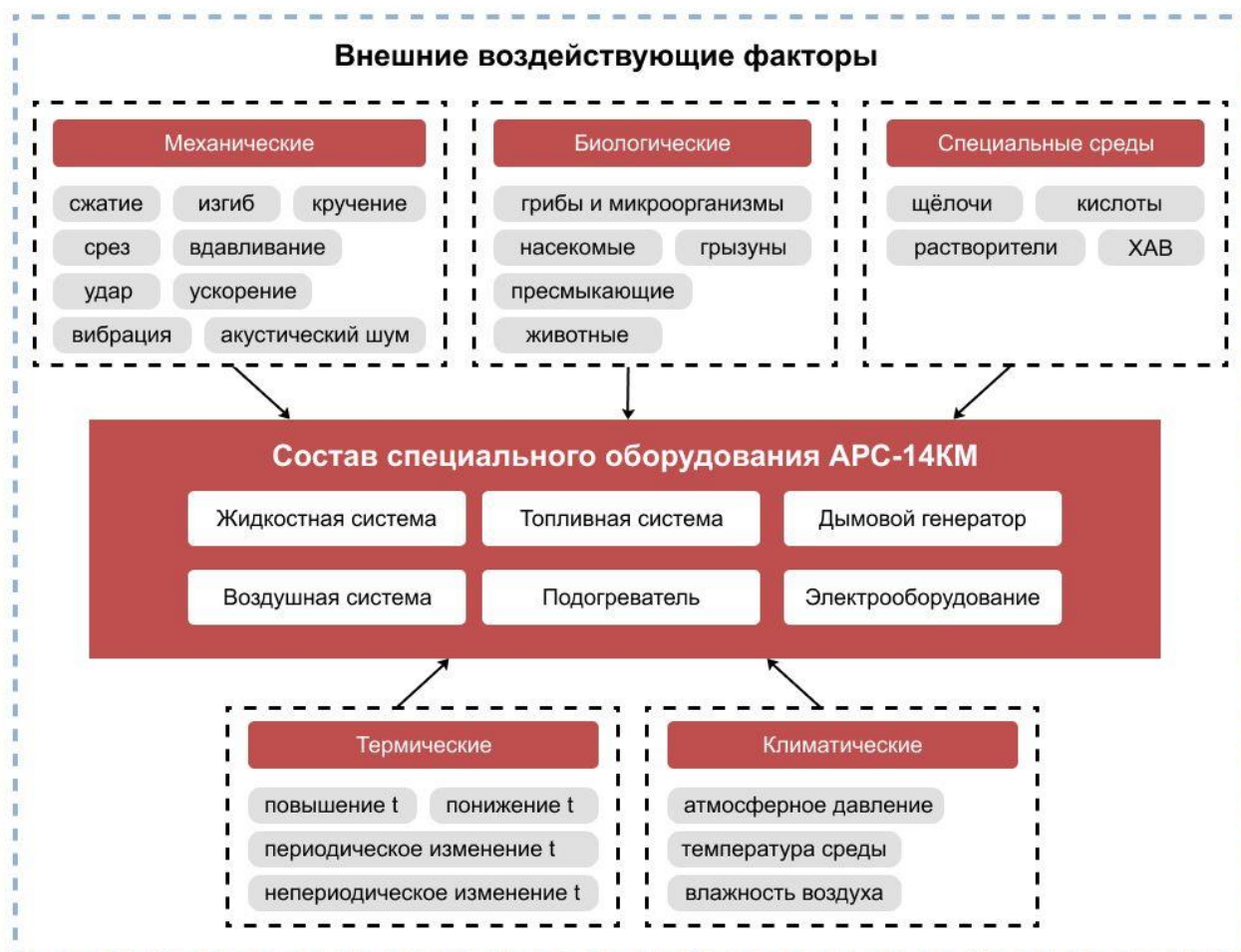
Рис. 1 Влияние внешних воздействующих факторов на состав специального оборудования APC-14KM
