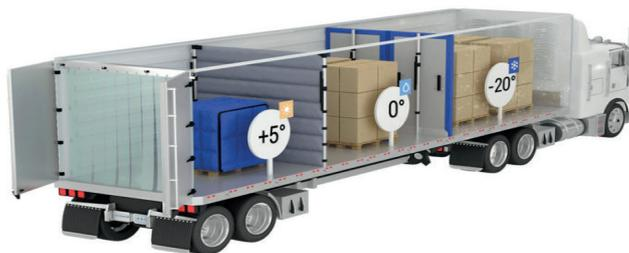
Рисунок 2. Размещение при разных температурах перевозки в авторефрижераторе
