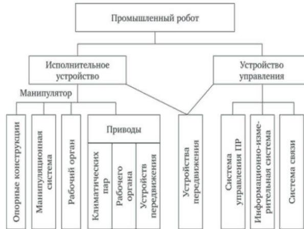
Рисунок 1. Упрощенная блок-схема промышленного робота
