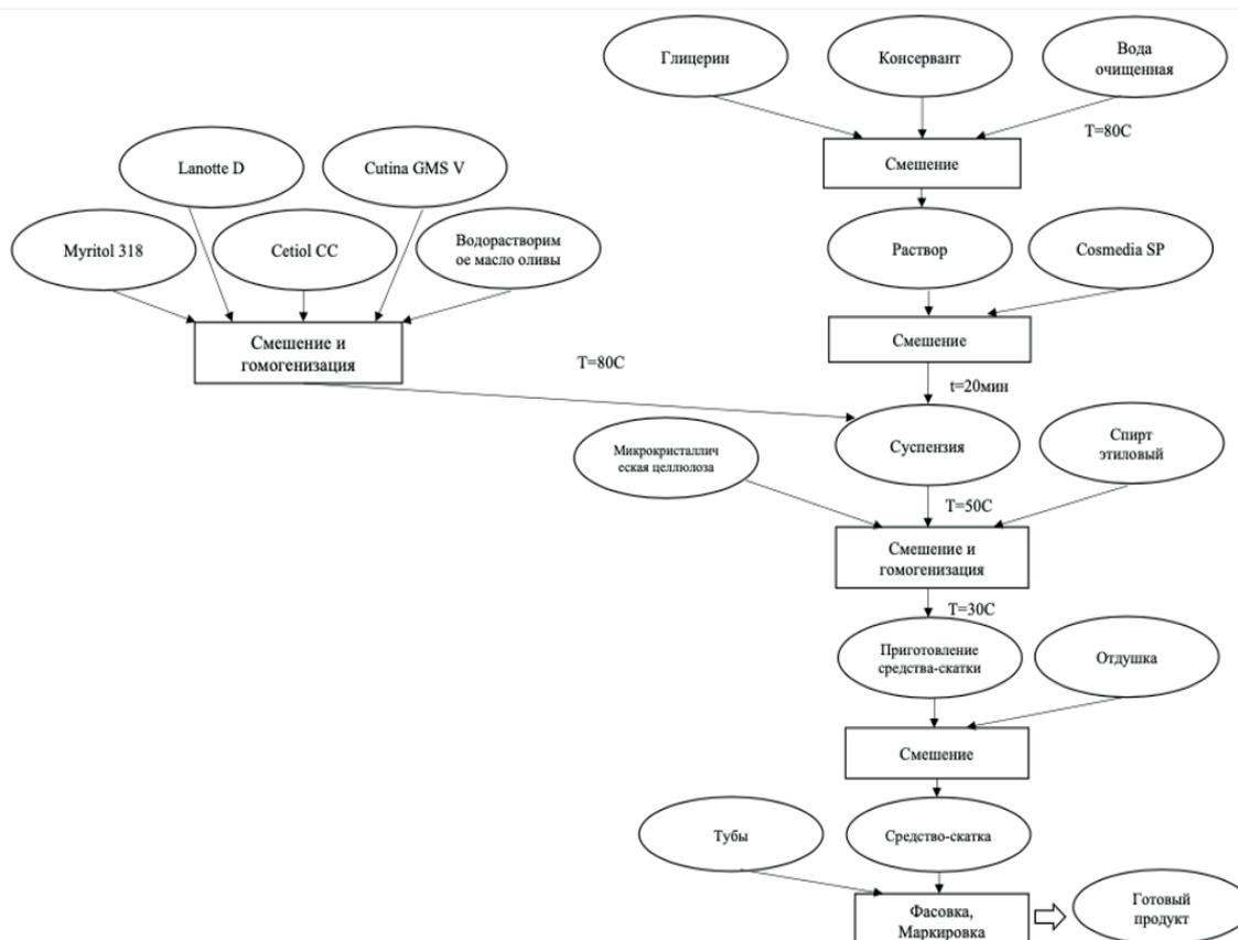
Рисунок 2. Процессуальная схема
