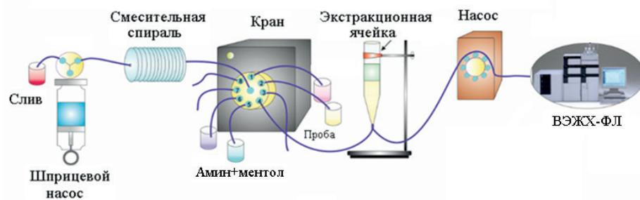
Рисунок 3. Автоматизированная схема определения бисфенола А
