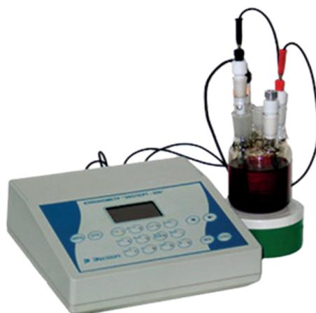
Рисунок 1. Анализатор кулонометрический «ЭКСПЕРТ-006»
