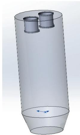
**Рисунок 1. 3D модель сушилки псевдооживленного слоя**
