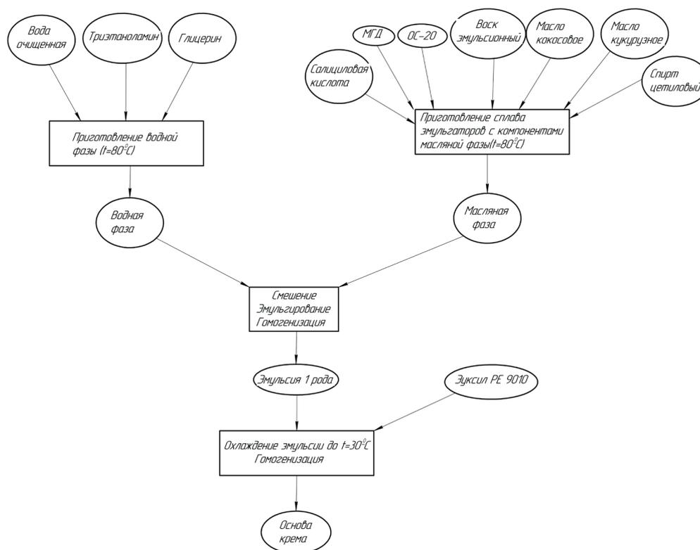
Рисунок 1. Процессуальная схема получения основы для эмульсионного крема
