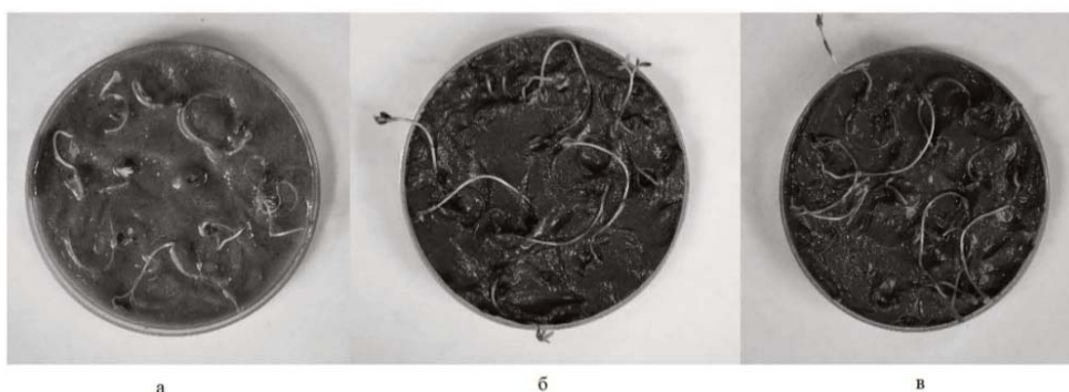
Рис. 2. Общий вид фитотестирования на песке (а), супеси (б) и суглинке (в) в чашках Петри с использованием культуры кресс-салата ( Lepidium sativum ).
