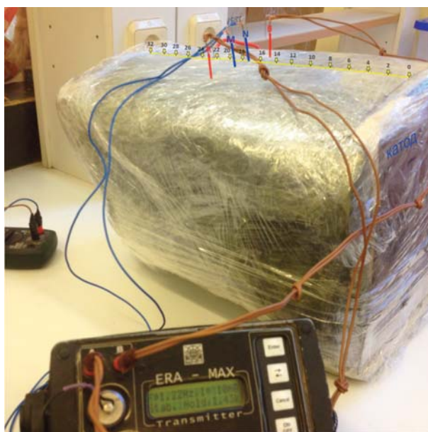
Рис. 3. Схема расположения профиля и электроразведочной установки.
