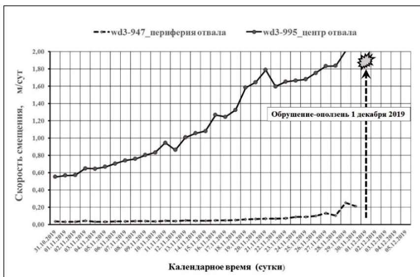
Рис. 4. Характер изменения скорости смещения для разных частей отвалов Лысый в ноябре 2019 г. - до их обрушения.
