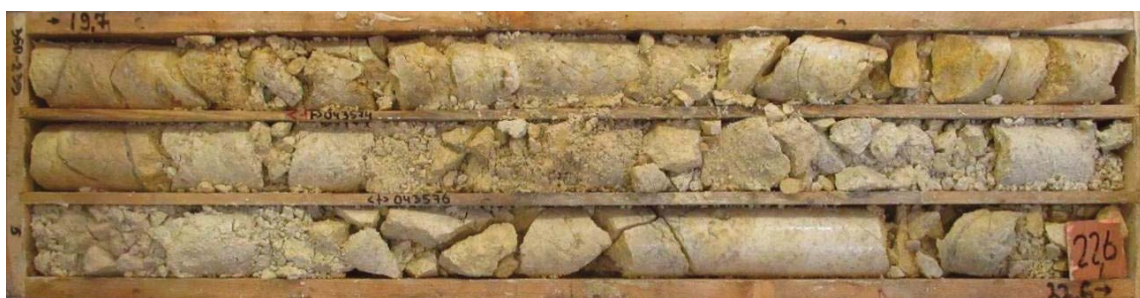
Рис. 5. Зона ослабления, представленная дресвой и щебнем малопрочными.
