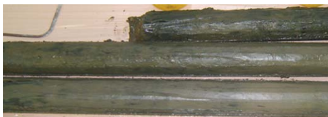
Рис. 1. Характерный вид морских верхнеплейстоцен-голоценовых отложений. Ил переходящий в текучий суглинок.
