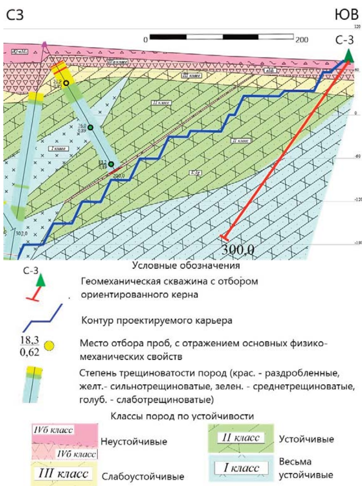
Рис. 1. Фрагмент прогнозного инженерно-геологического разреза одного из участков месторождения.
