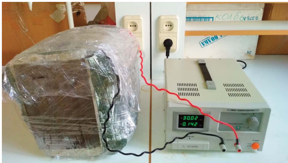
Рис. 2. Установка для поляризации образца постоянным током.
