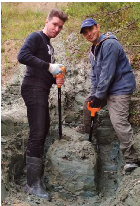
Рис. 1. Отбор монолита грунта для исследования.
