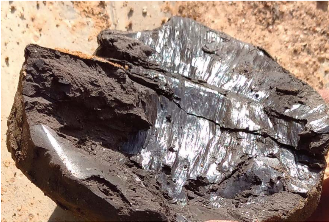
Рис. 2. Вид зеркала скольжения в глинах подмосковной свиты.
