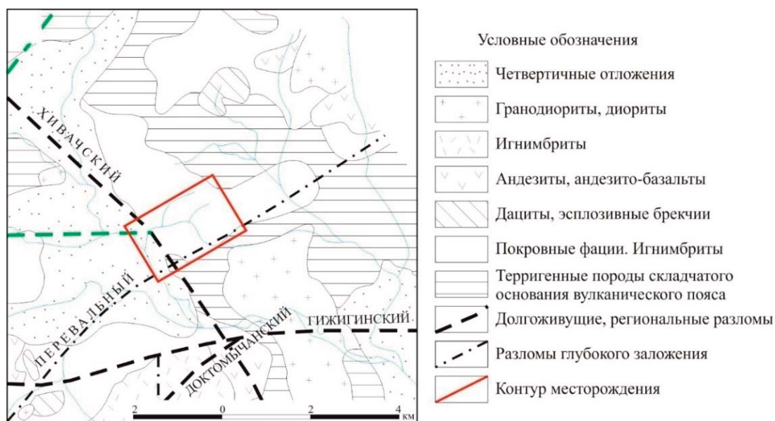
Рис. 3. Геолого-структурная схема месторождения.
