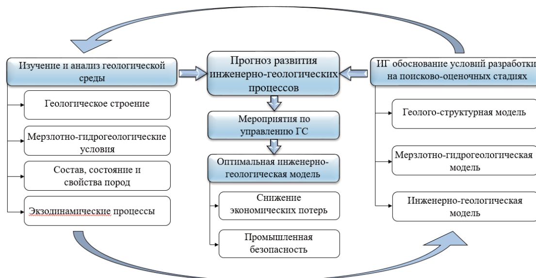
Рис. 2. Схема последовательности изучения условий для разработки месторождения полезных ископаемых.
