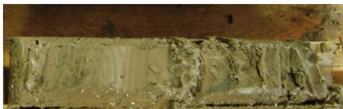
Рис. 2. Характерный вид приповерхностного слоя супеси в интервале 0,0 -1,50 м.
