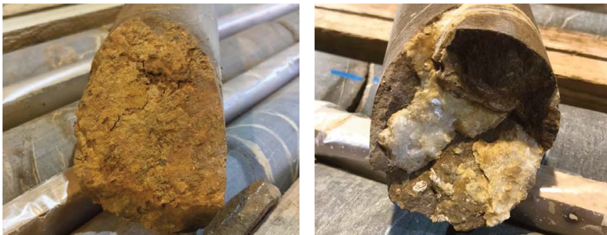
Рис. 4. Глинистый наполнитель открытой трещины (слева), кварц-карбонатный наполнитель (справа).
