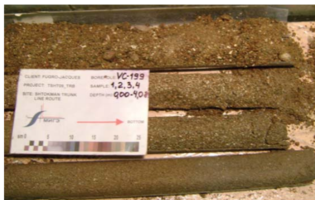
Рис. 3. Характерный вид песчаных грунтов на участке берегового примыкания трубопровода.
