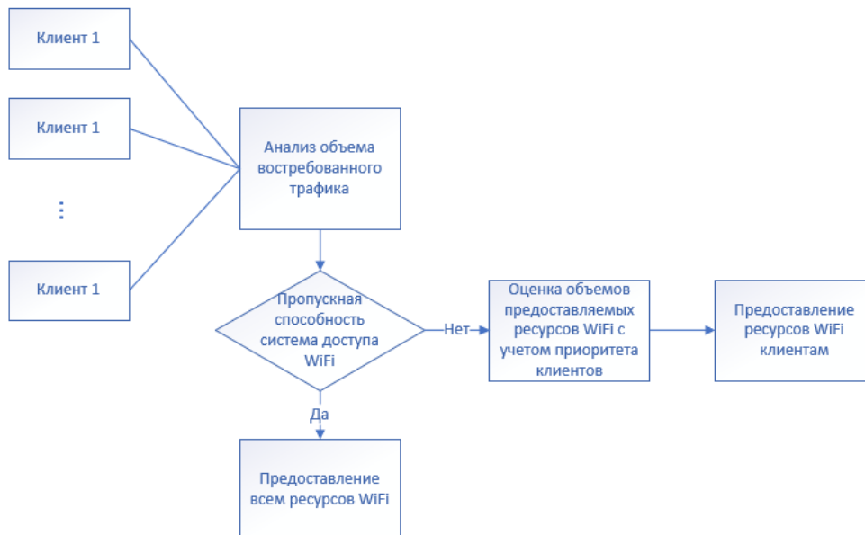
Рис.1 Схема работы сервиса по приоритизации трафика беспроводной сети
