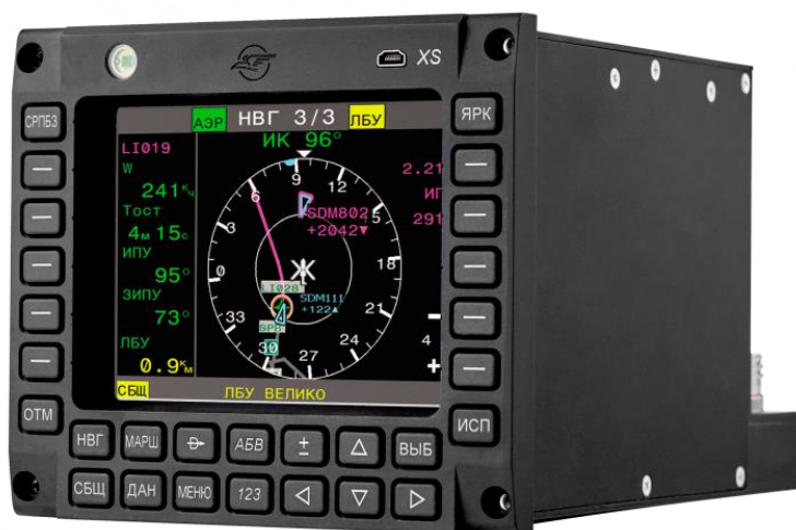
Рисунок 4 - Внешний вид блока СНС
