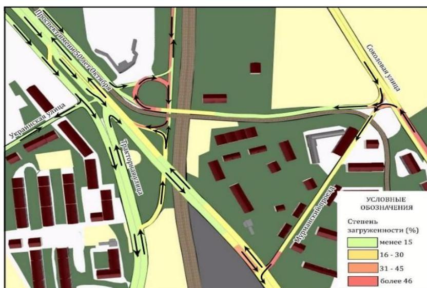
Рисунок 2. Сложившаяся дорожная ситуация в имитируемом потоке на усовершенствованной развязке (вариант 1), выполненная в программе PTV VISSIM 8 (student), составлен автором
