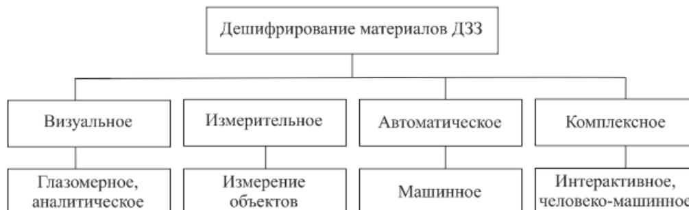
Рисунок 1. Схема дешифрирования материалов ДЗЗ, составлено автором
