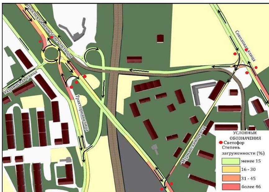
Рисунок 3. Сложившаяся дорожная ситуация в имитируемом потоке на усовершенствованной развязке (вариант 2), выполненная в программе PTV VISSIM 8 (student), составлен автором
