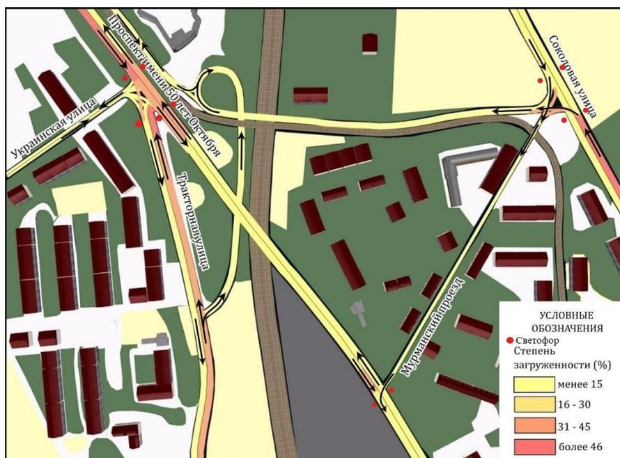
Рисунок 1. Сложившаяся дорожная ситуация в имитируемом потоке, выполненная в программе PTV VISSIM 8 (student), составлен автором
