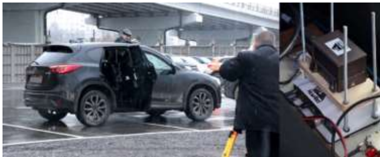
Рисунок 1. Подготовка к испытаниям. Установка ГНСС+ИНС оборудования на автомобиль
