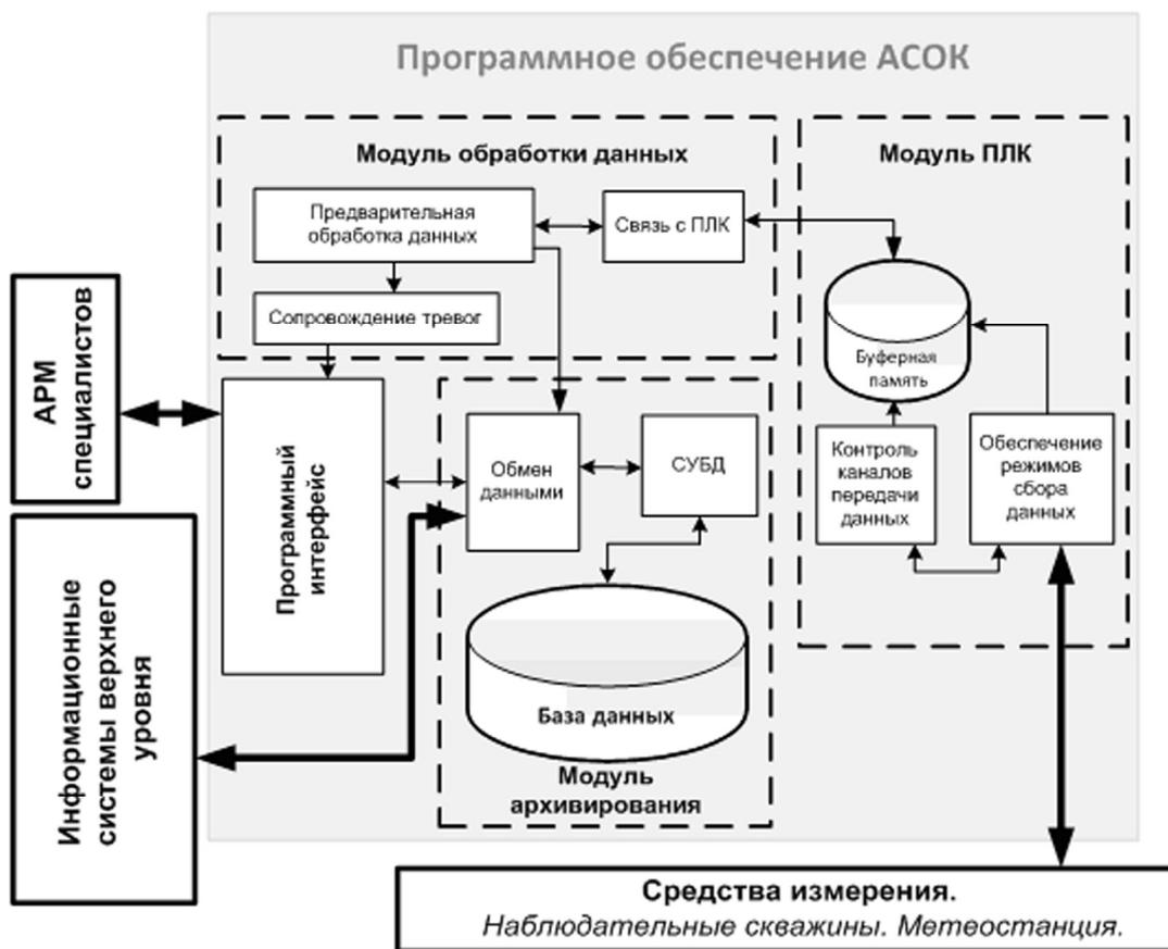
Рис. 2. Структура программного обеспечения АСОК
