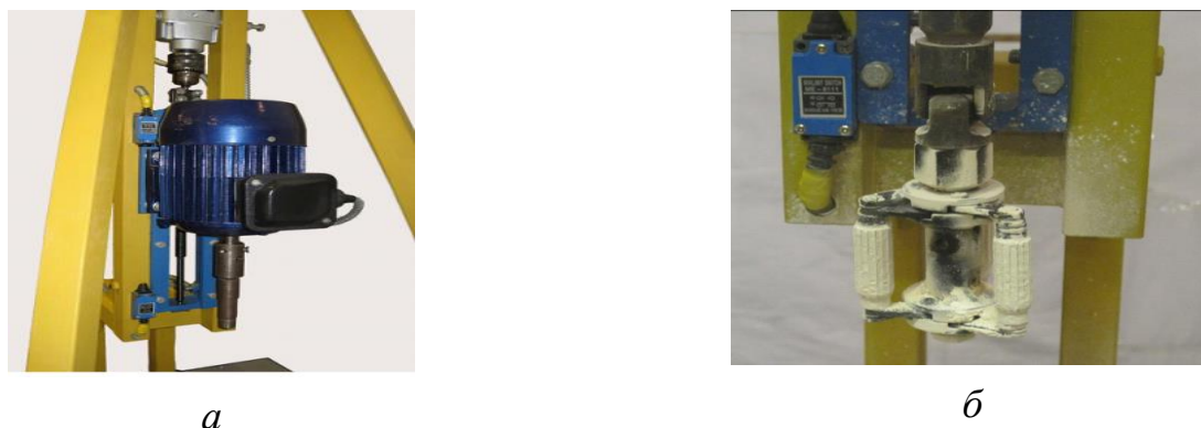
Рисунок 2 - Экспериментальное оборудование по исследованию процесса очистки: а – привод установки; б – инструмент
