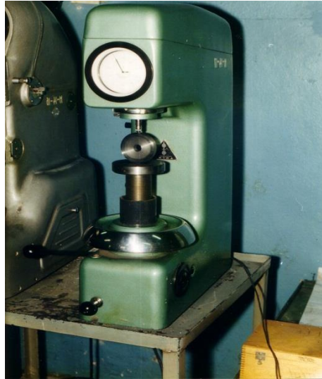
Рисунок 4 – Измерение твердости поверхности образцов
