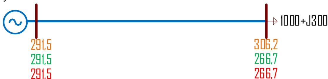
Рисунок 5. Уровни напряжения при передаче по ВЛ мощности больше натуральной.
