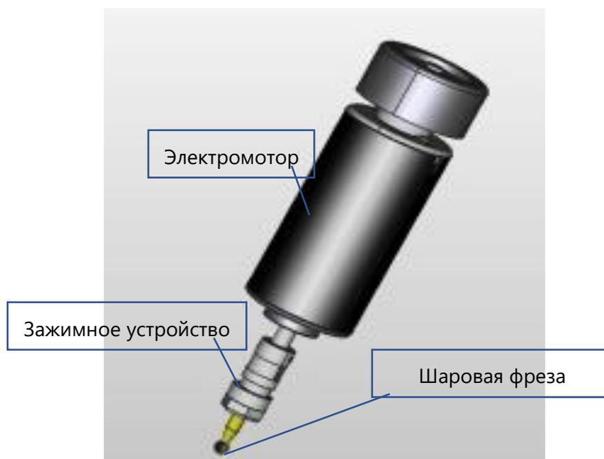
Рисунок 2. Шпиндель с шаровой фрезой
