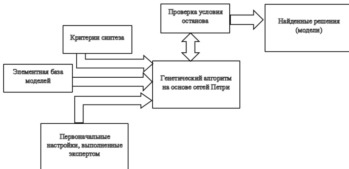
Рисунок 1 – Пример использования генетического алгоритма при решении задачи структурно-параметрического синтеза больших дискретных систем с заданным поведением
