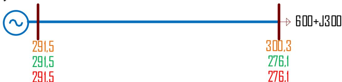
Рисунок 6. Уровни напряжения при передаче по ВЛ мощности меньше натуральной.
