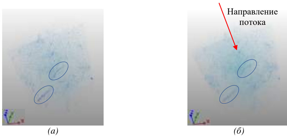
Рисунок 2 Пустоты в кернавом образце. Оттенки синего — пустоты, матрица не показана, (а) — до фильтрации; (б) – после фильтрации.
