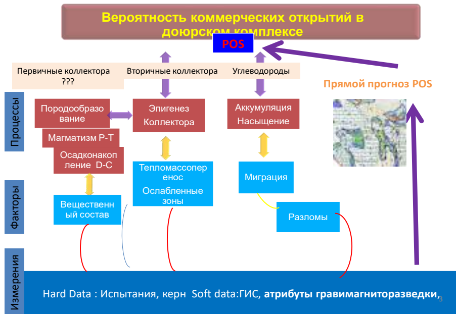
Рисунок 2. Когнитивная карта комплексной интерпретации данных гравимагниторазведки для поисков залежей в ДЮК. На вставке в правой части фрагмент карты прогноза вероятности открытия по аналогии с известными залежами.
