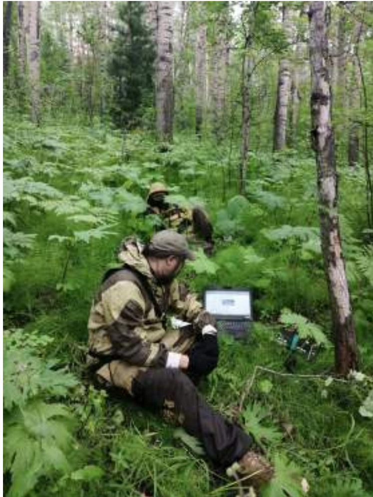
Рисунок 2. Рабочие моменты при регистрации ЕИЭМПЗ по сети профилей на рассматриваемой площади. Выполняется регистрация ЕЭМИ на рядовой точке профиля.
