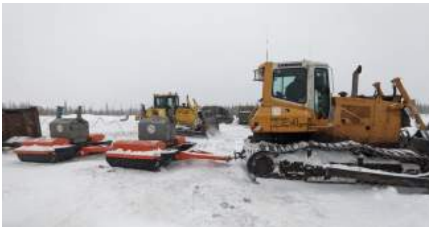
Рисунок 1. Бульдозер, буксирующий сцепку из двух импульсных источников «Енисей СЭМ-100», применяемых в движении при работах МОГТ 3D.
