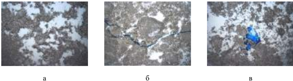
Рисунок 2. Примеры фотографий шлифов для скважин II типа а) интенсивное засолонение б) сохраненная микротрещиноватость в) единичная не сообщающаяся каверна
