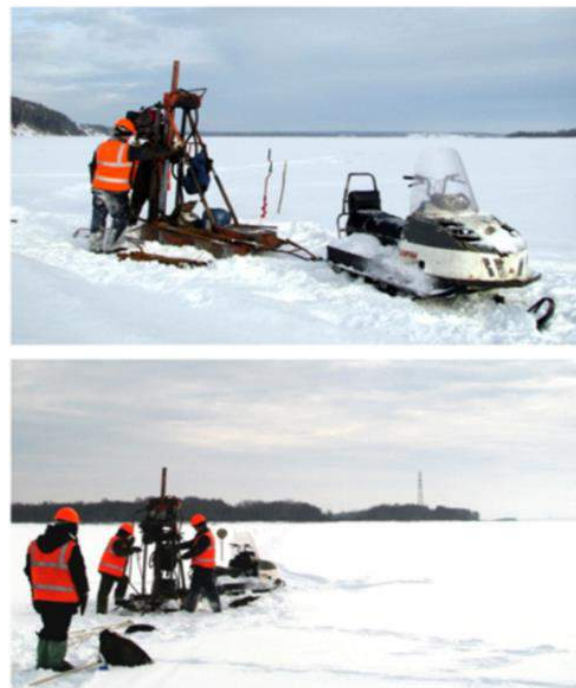
Рис. 1. Схема бурения взрывных скважин малогабаритной буровой установкой «УБШМ-1-13» на водоемах
