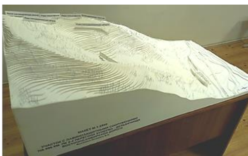
Рисунок 8 – Фото макета № 1 лавиноопасного очага № 65 на перегоне Кунерма – Дельбичинда и запроектированной комплексной системы лавинозащиты железной дороги; макет разработан дипломником В. Осколковым
