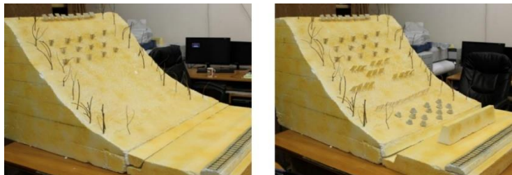
Рисунок 10 – Фото макета № 3 условного лавиноопасного очага; слева – первый «исходный» вариант лавинозащиты; справа – второй «усиленный» вариант лавинозащиты; макет разработан дипломником С.А. Баиновым
