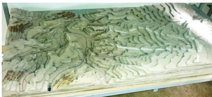
Рисунок 5 – Макет рельефа местности с нанесенными водоразделами, постоянными водотоками, опасными инженерно-геологическими процессами: курумами и оползнями
