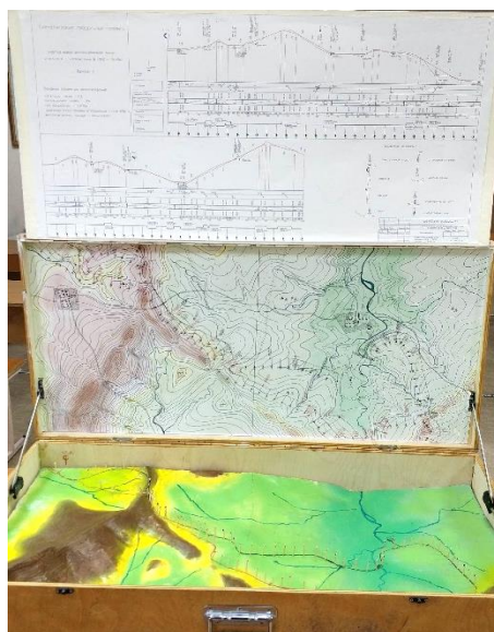
Рисунок 4 – Общий вид раскрытого комплексного макета рельефа местности, топографической карты с вариантами трассы и продольного профиля
