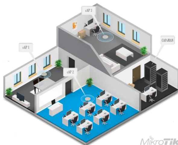
Рисунок 2 - Настройка CAPsMAN на MikroTik (бесшовный роуминг)
