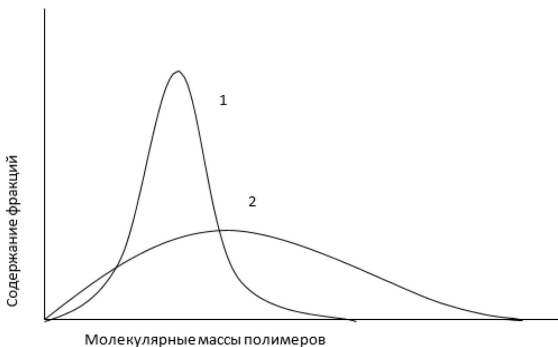
**Рисунок 1. Примерный вид дифференциальной кривой молекулярно-массового распределения: 1 – узкое ММР; 2 – широкое ММР**
