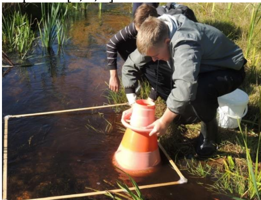
Рисунок 3. Просмотр дна реки через акваскоп
