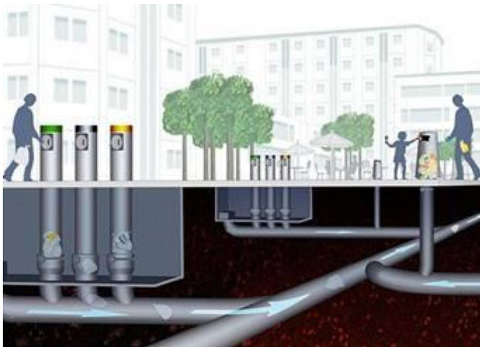
**Рисунок 1. Пневматическая система мусороудаления**
