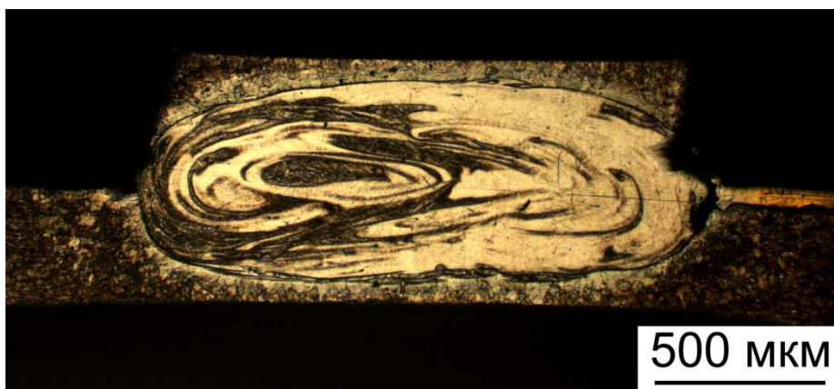
Рис. 6 – Микроструктура литого ядра, выполненного в первом режиме
