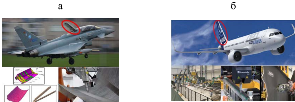
Рис. 2 – Применение ПАД в изготовлении различных конструкций АТ выполненных из ПКМ: а – изготовление воздушного тормоза самолета Eurofighter Typhoon; б – сборка вертикального оперения самолета А320
