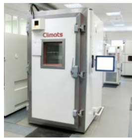
Климатическая камера для имитации годового цикла с системой излучения с металлогалогеновой лампой
