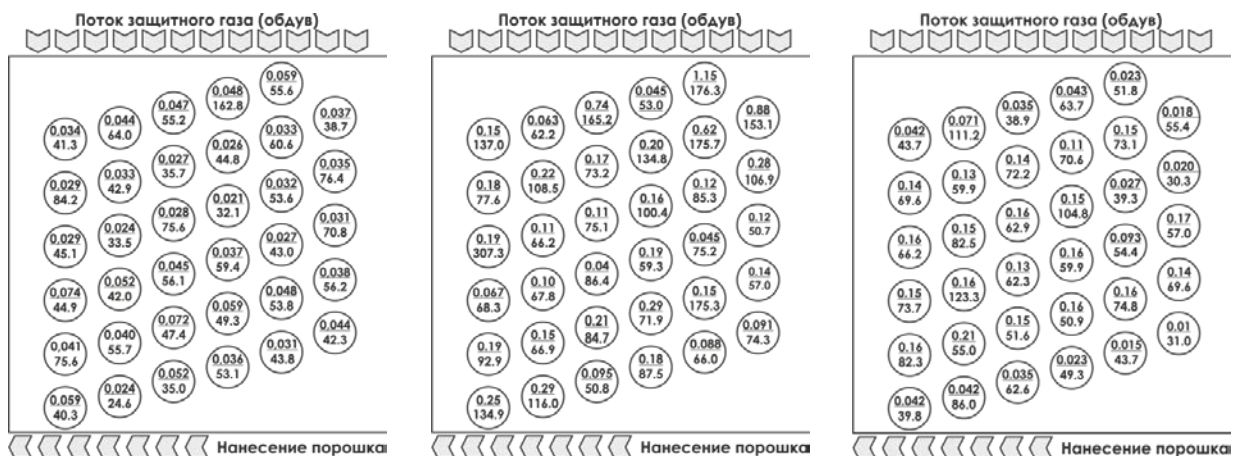
Рис. 5 – Результаты количественного металлографического анализа для стартов 1, 2 и 3 (в числителе указана объемная доля пор (в %), в знаменателе – максимальный размер пор в мкм)
