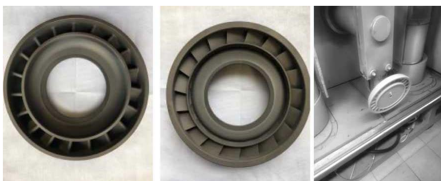
Рис. 3в – Внешний вид соплового аппарата со стороны входной и выходной кромки, расположение соплового аппарата на оси малого ротора
