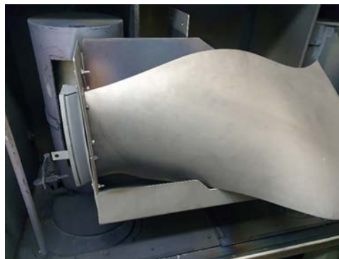
Рис. 3б – Лопатка вентилятора ГТД в установке МАИ-Р с нанесенным фреттингостойким покрытием на подошве замка
