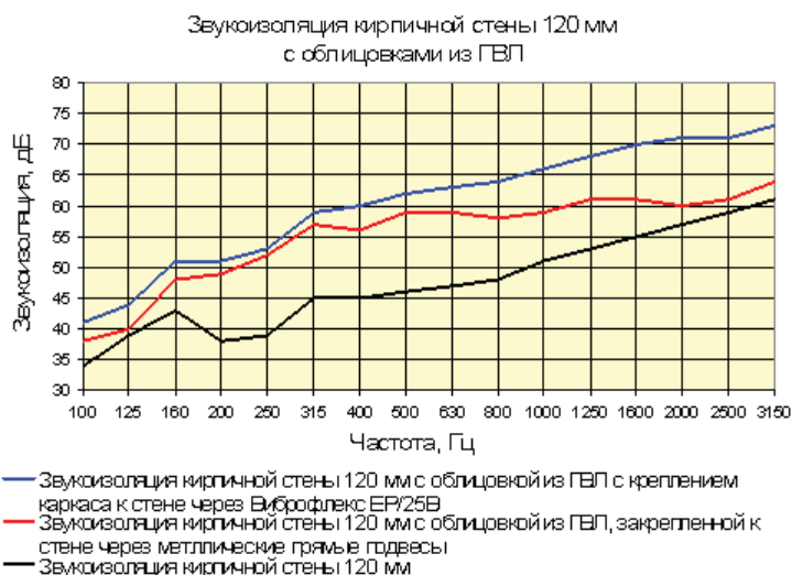
Рис.6. График эффективности звукопоглощения применяемых панелей
