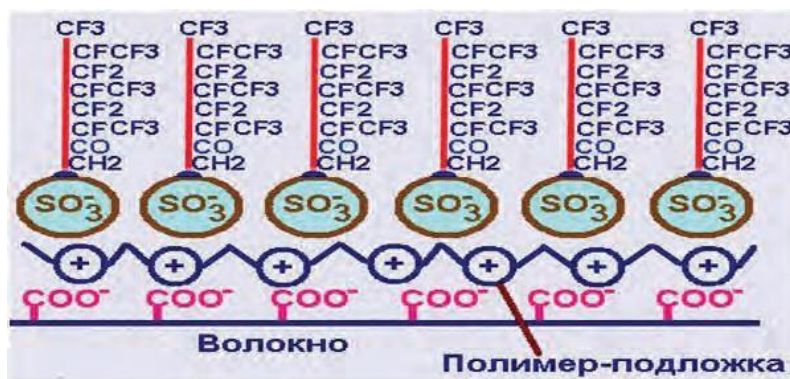
Рис.3. Формирование бимолекулярного слоя фтор-Пав с «якорным» полимером.
