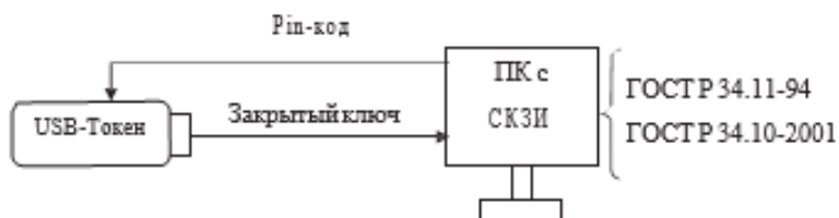
Рис. 1. Обмен информацией между ПК и Токеном с извлекаемым закрытым ключом
