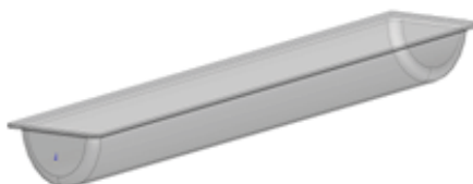
Рис.3. Форма защитного стекла модульного светильника
