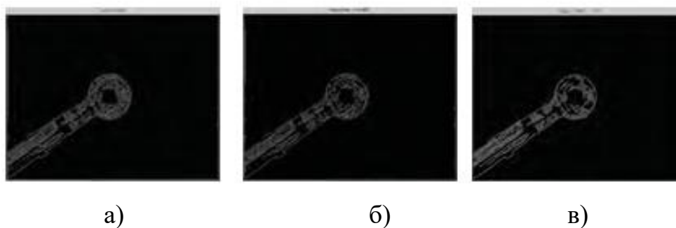
Рис. 4. Обработанное изображение фильтрами второй производной: а) Лапласиан - Гауссиана, б) Марра - Хилдрета, в) Кэнни
