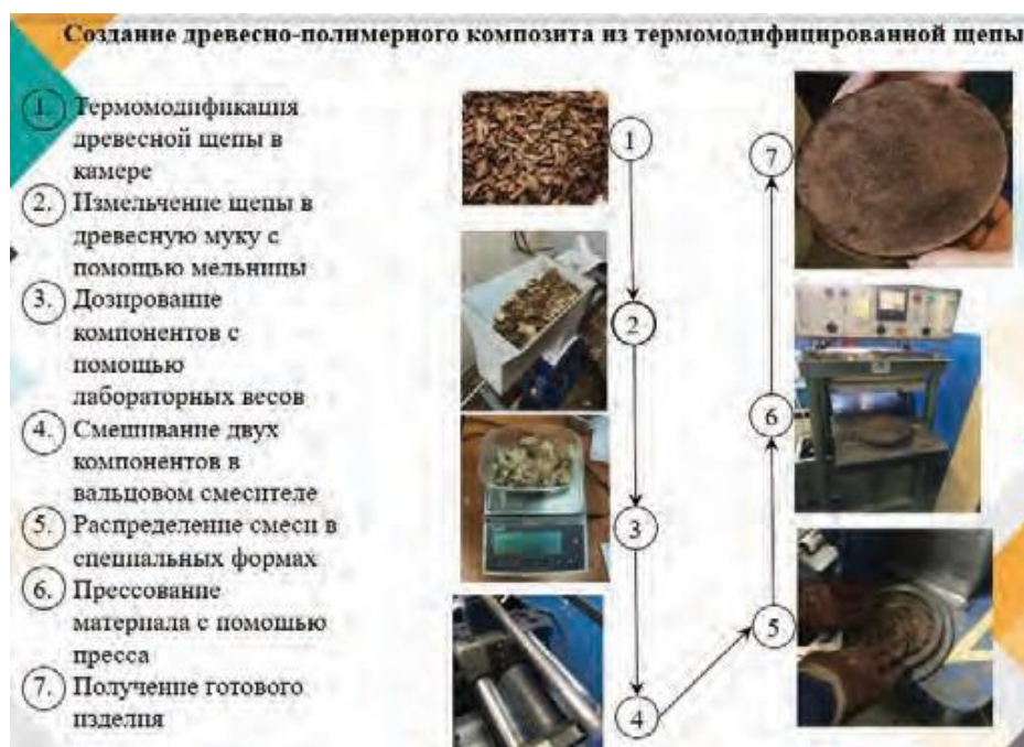
Рисунок. 1. Стадии создания древесно - полимерного композита из термомодифицированной щепы
