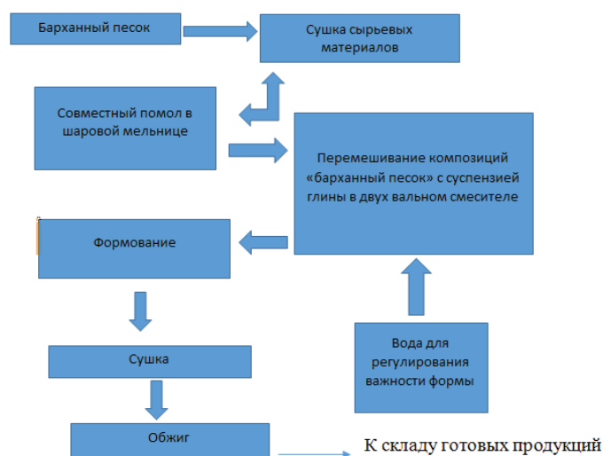
Рисунок 1. Принципиальная технологическая схема производства ремонтных составов (стенные отделочные материалы) на основе барханного песка
