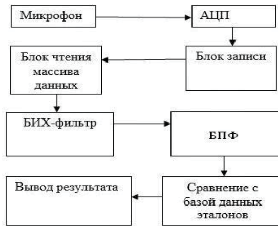
Рисунок 2 – Последовательность процедур при идентификации фрагментов звуковых сигналов
