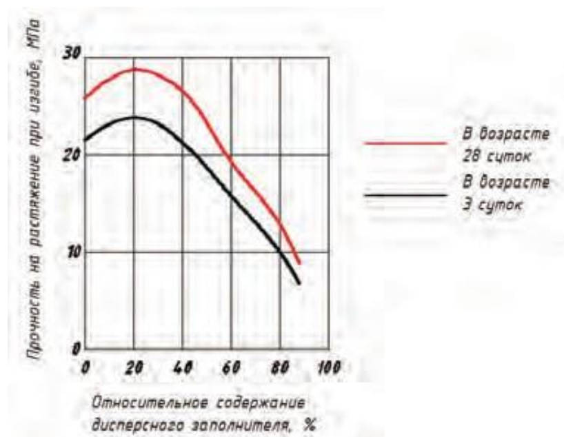
Рисунок 2 - Зависимости прочности при изгибе от содержания цемента М 500
