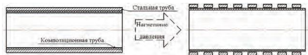
Рис.1. Процесс ремонта трубопроводов протягиванием внутри них композиционных.
