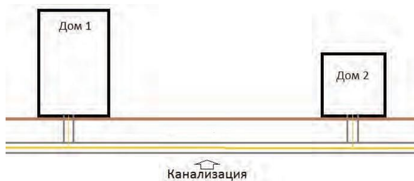
Рис.3 Прокладка оптоволокна через канализацию
