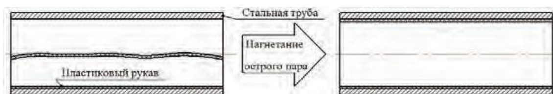
Рис.2. Процесс ремонта трубопроводов протягиванием рукава.
