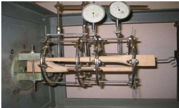
Рис. 6. Стенд для исследования жесткости остеосинтеза.
