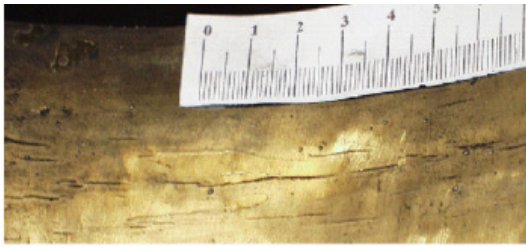
Рис. 7. Вид поперечного сечения образца, вырезанного из зоны расслоения (к статье М.С. Сайковой).
