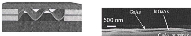
Рис. 2. Гофрировка с фиксированной амплитудой и периодом. Справа — фотография, сделанная электронным микроскопом.
