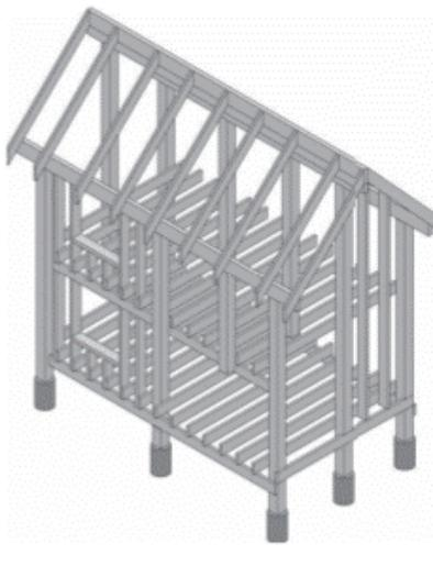
Рисунок 4. Стоечная конструкция
