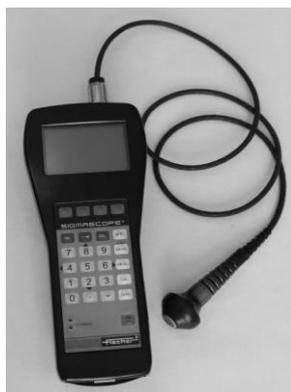
Рисунок 1 – Измеритель электропроводности «SIGMASCOPE SMP10»
