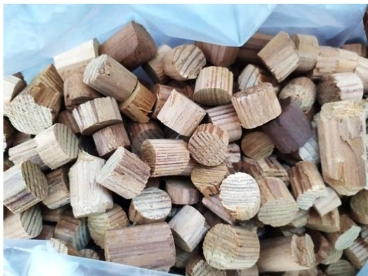
Рисунок 1 - Термически модифицированная древесина в виде гранул
