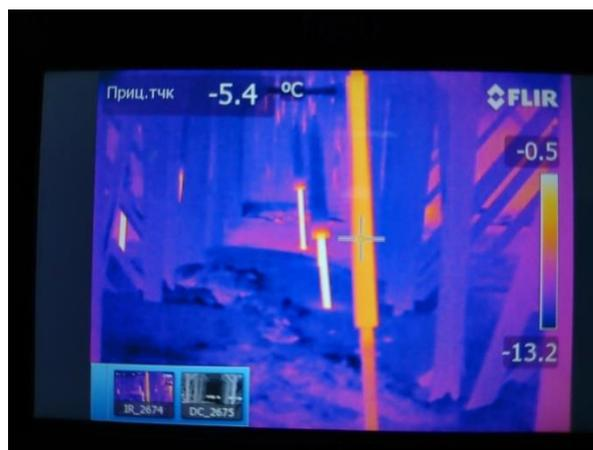
Рисунок 3 - Результаты проверки работы термостабилизатора с металлорукавом Ду16 посредством тепловизионной съемки.
