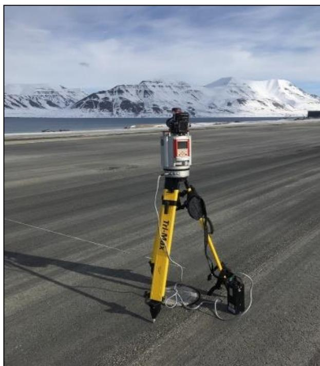
Рис. 2. Лазерный сканер Riegl VZ-1000 (фото: Юров Ф.Д.).
