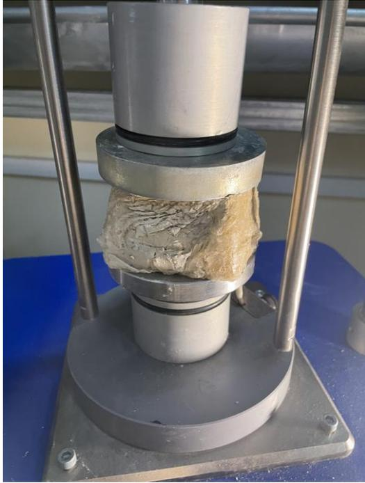
Рис. 1. Вид образца замороженной каолиновой глины с массовой влажностью 120% после испытания на одноосное сжатие.
