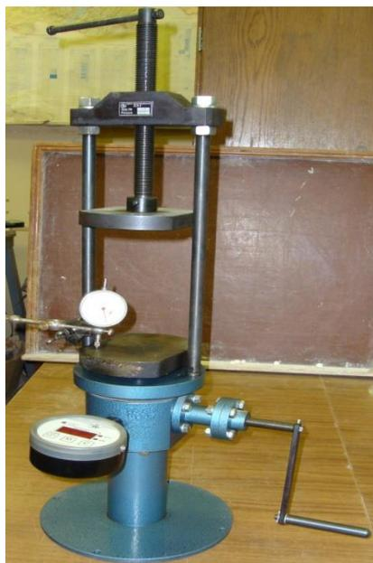
Рис. 1. Гидравлический пресс ПРГ-1-10 для кратковременных испытаний мерзлых грунтов.
