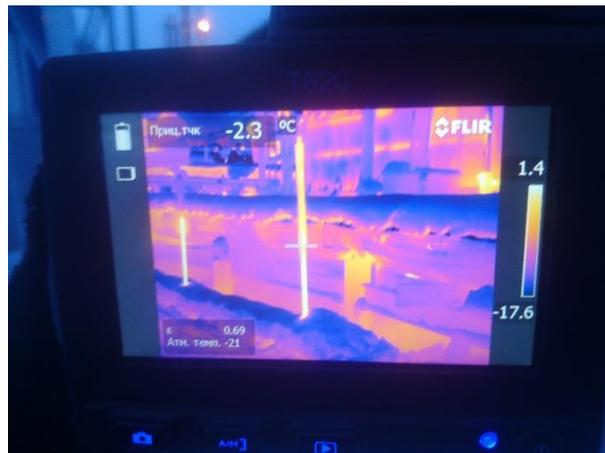
После снятия защитного кожуха с радиатора термостабилизатора
