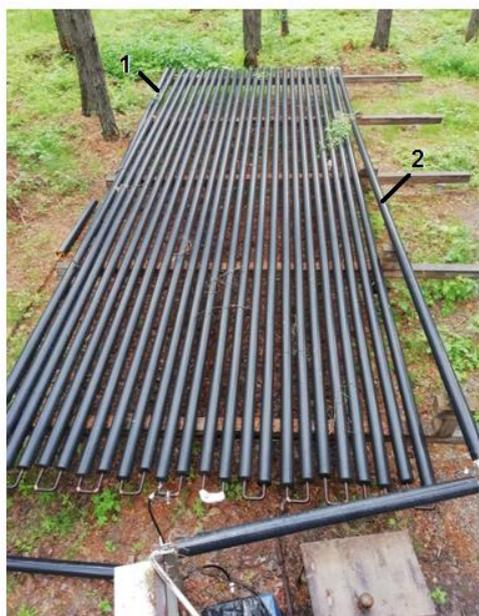
Рисунок 2 – Испарительная система экспериментальной установки. Трубы №№ 1 и 2 образуют такой угол с горизонтальной поверхностью, чтобы пар мог двигаться только в одном направлении от трубы 1 к трубе 2.
