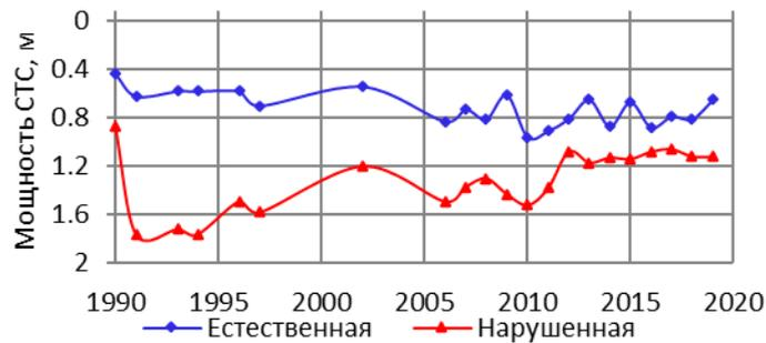
Рис. 1. Динамика мощности сезонно-талого слоя в сфагново-багульниково-ерниковой лиственничной речине (естественная) и при удалении напочвенного покрова (нарушенная) в межгрядово-низинном типе местности на трассе железной дороги Томмот – Нижний Бестях
