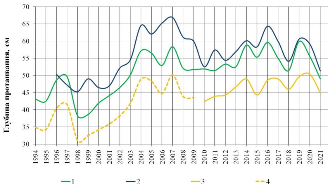
Рис.1. Динамика сезонного протаивания на площадках: 1 – Онемен, 2 – Дионисий, 3 – Круглая (наблюденная), 4 – Круглая (интерполяция)
