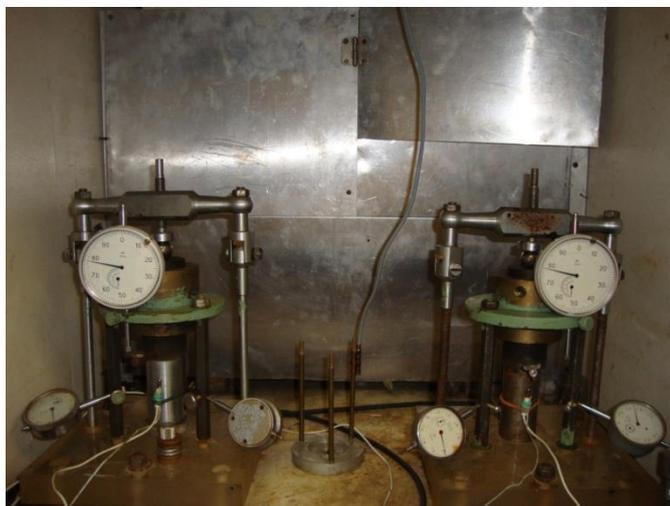
Рис. 2. Приборы одноосного сжатия для испытания мерзлых грунтов на ползучесть.
