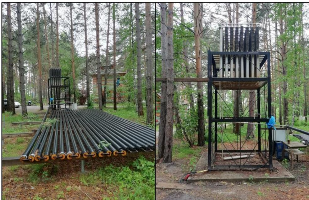
Рисунок 1 – Общий вид экспериментальной установки: слева – испаритель (ближе) и конденсатор (дальше), справа – конденсатор
