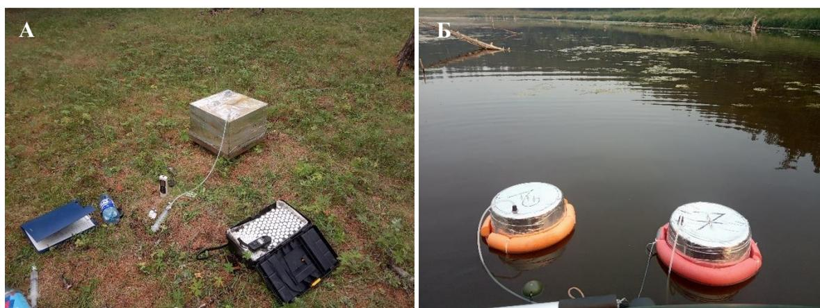
Рисунок 4. Полевые измерения удельных потоков парниковых газов: А — статические, Б — плавающие камеры.
