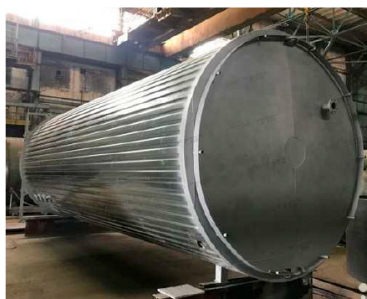
Рис. 1: Реальные конструкции: цилиндрическая оболочка с присоединенной торцевой пластиной.
