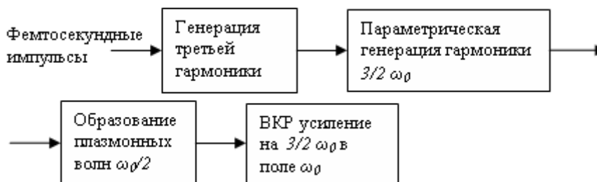
Рис. 5. Схема генерации гармоники 3/2 \omega_0
