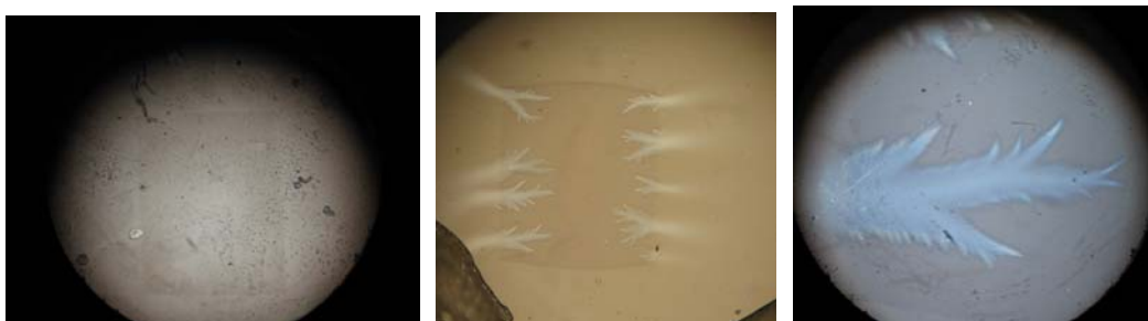
Рис. 3. Оптические изображения облученных электронами областей с металлическими нанокластерами в стеклах: AgBr (слева), CuCl (в середине и справа). Размер области 270 x 350 мкм 2 . Образование Ag нанокластеров происходит при отжиге 540 С в течение 2 часов
