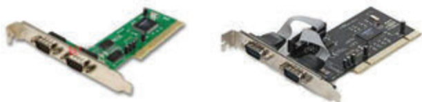
Рис. 1. Внешний вид платы расширения, содержащей Com-порты
