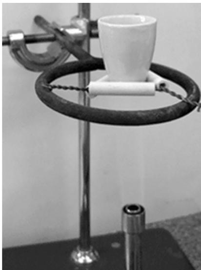
Рис. 1. Схема установки прокаливания тигля на пламени горелки.
