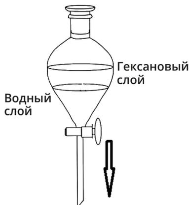
Рис. 3. Схема разделения водного и органического растворов
