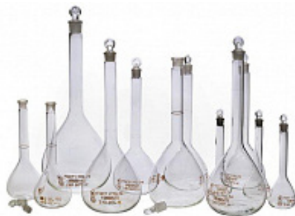
Рис. 7. Внешний вид мерных колб различной вместимости.
