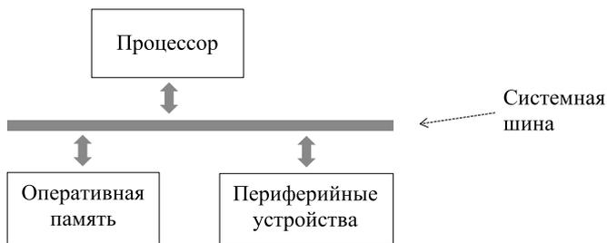
Рис. 9. Общая схема типовой ЭВМ, основанной на архитектуре фон Неймана
