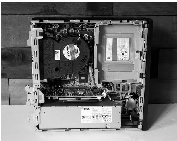
**Рис. 12.** Системный блок Dell OptiPlex 7060 со снятой крышкой
