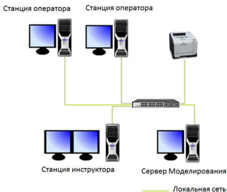
Рисунок 3 – Архитектура тренажерного комплекса
