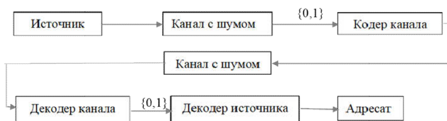
Рисунок 1 – Обобщенная структурная схема системы передачи сообщений
