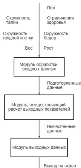
Рис. 1. Схема работы модулей программы
