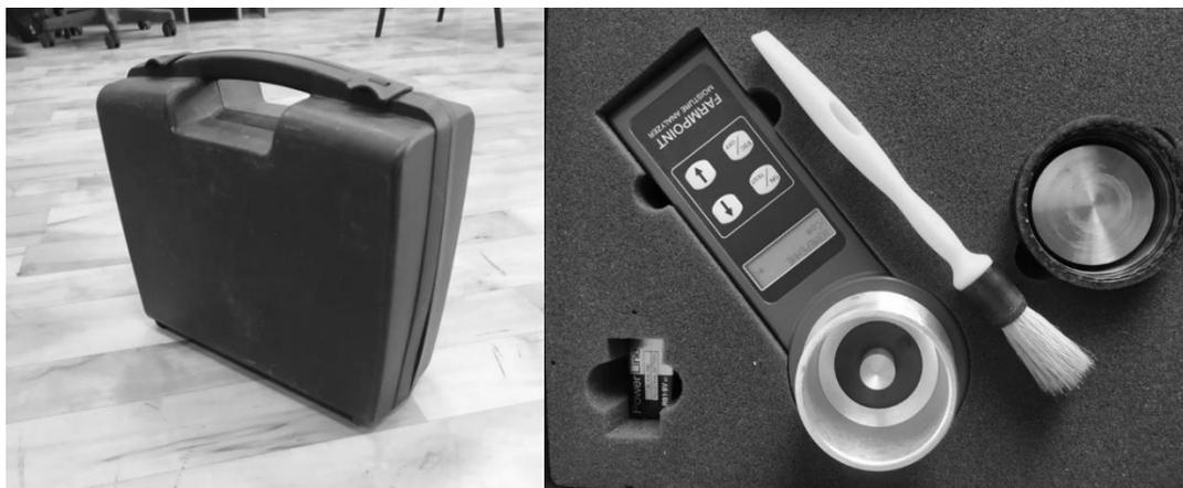
Рисунок 2. Прибор для определения влажности зерна
