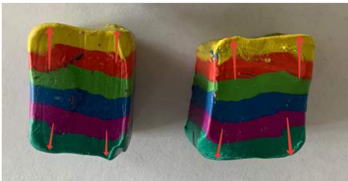
Рис. 5. Направление течения металла после 4-го прохода (образец № 2)
