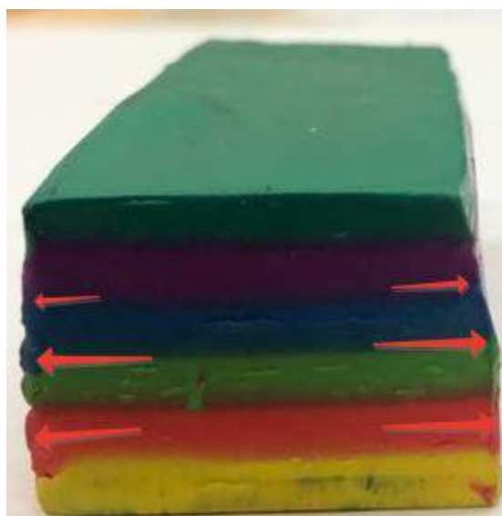
Рис. 1. Направление течения металла после первого прохода
