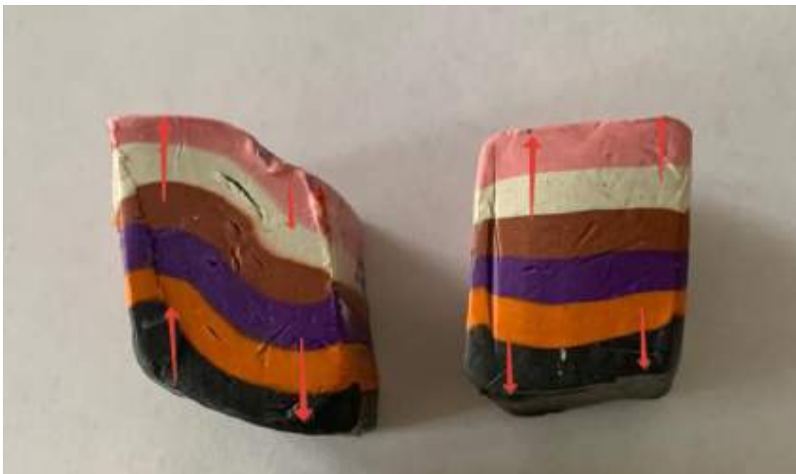
Рис. 4. Направление течения металла после 4-го прохода (образец №1)
