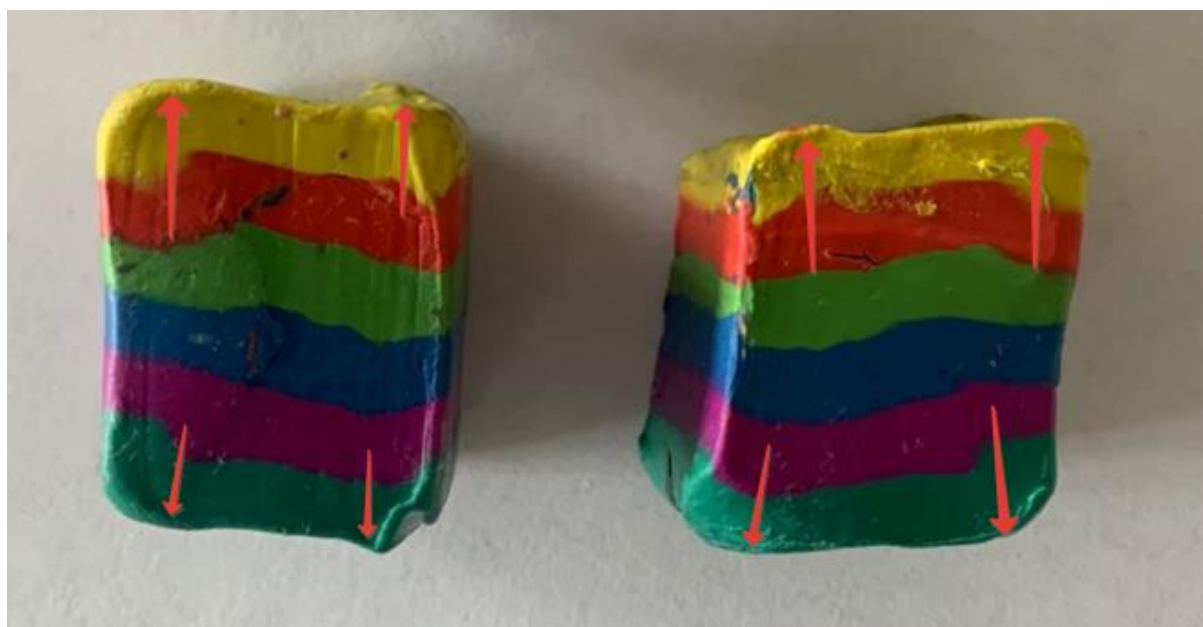
Рис. 5. Направление течения металла после 4-го прохода (образец № 2)
