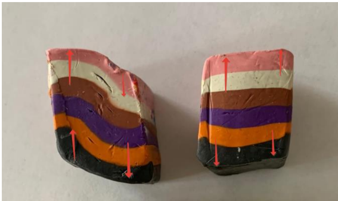
Рис. 4. Направление течения металла после 4-го прохода (образец №1)
