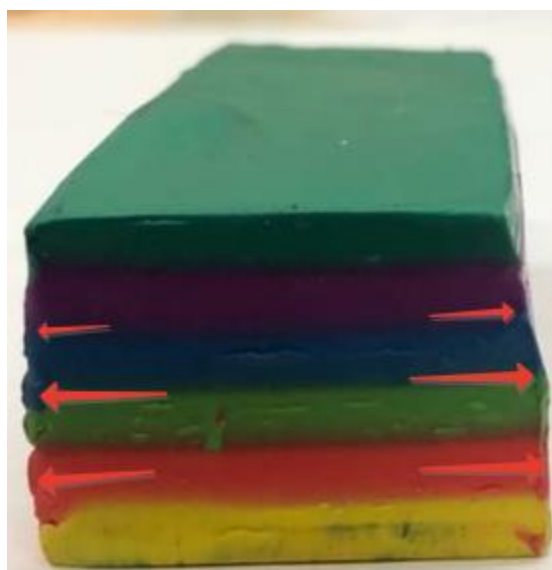
Рис. 1. Направление течения металла после первого прохода
