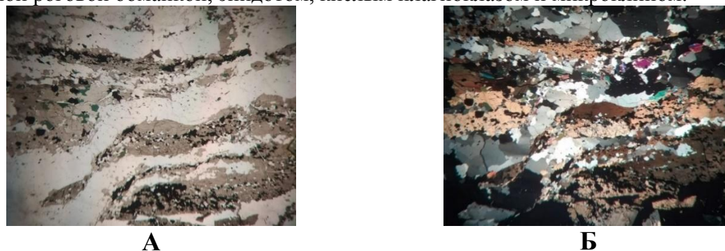
Рис. 3. Шлиф 605-32.5. А–проходящий свет; Б–поляризованный свет. Магнетит-грюнеритовый кварцит, руда II типа. Мобилизация магнетита в тонкие деформированные прослои на контакте с кварцевыми прожилками.
