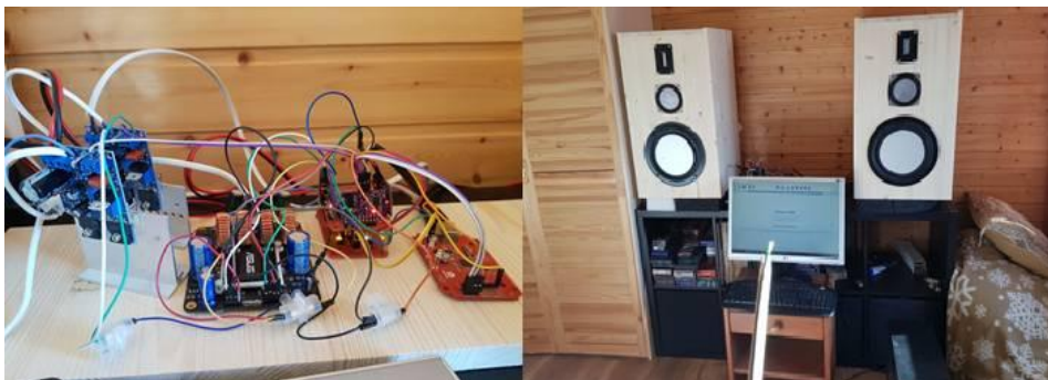
Рисунок 2 – ADAU1452 вместе с 3хPCM5102A, 3хPCM1808, кварцевым генератором и усилителями (TPA3255 и на транзисторах IRFP448)
