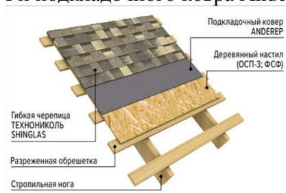
Рисунок 4 – Кровельный пирог устройства Битумная черепица ТехноНиколь SHINGLAS.
