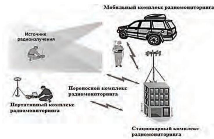
Рисунок 1 – Виды комплексов радиомониторинга
