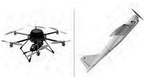
Рисунок 2. Беспилотные аппараты для радиоконтроля (слева беспилотный вертолет "Колибри", справа БПЛА "Орлан - 10")
